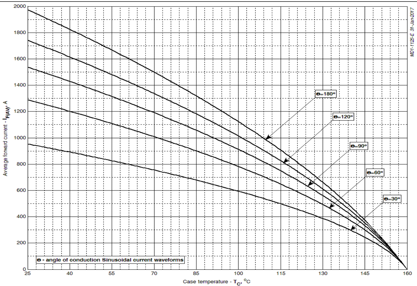
Рис. 5 - Зависимость среднего прямого тока I_{FAV} от температуры корпуса T_C для синусоидальной формы тока при различных углах проводимости ( f=50 Гц, Двустороннее охлаждение)
